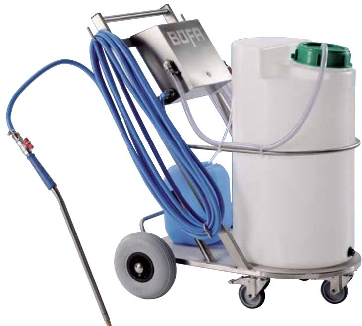
**SCHAUMHEXE 100 L** – fahrbar mit Lanze und Zubehör. Mit der Schaumhexe wird über eine mit Druckluft betriebene Pumpe Chemiekonzentrat angesaugt und in einem wählbaren Verhältnis dem Wasser aus dem Vorratsbehälter (100 l) zugemischt. Darüber hinaus kann auch eine fertig angemischte Verdünnung aus Chemie und Wasser vorgelegt werden. VA-Fahrwagen; 12 m Schaumschlauch; 10 m Luftschlauch 6 mm; Mindestdruck Luft: 8 bar.
